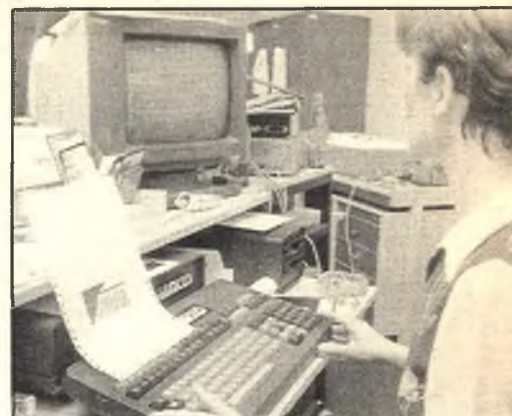
A Commodore-ból a szövegek az Amicus tördelőrendszerbe kerültek. Hogy szedés legyen a szövegből, ehhez még itt is sok kódot, utasítást kellett beírni
