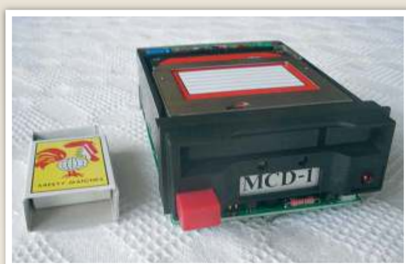
Az MCD-1 floppy, a meghajtó és benne az adathordozó
