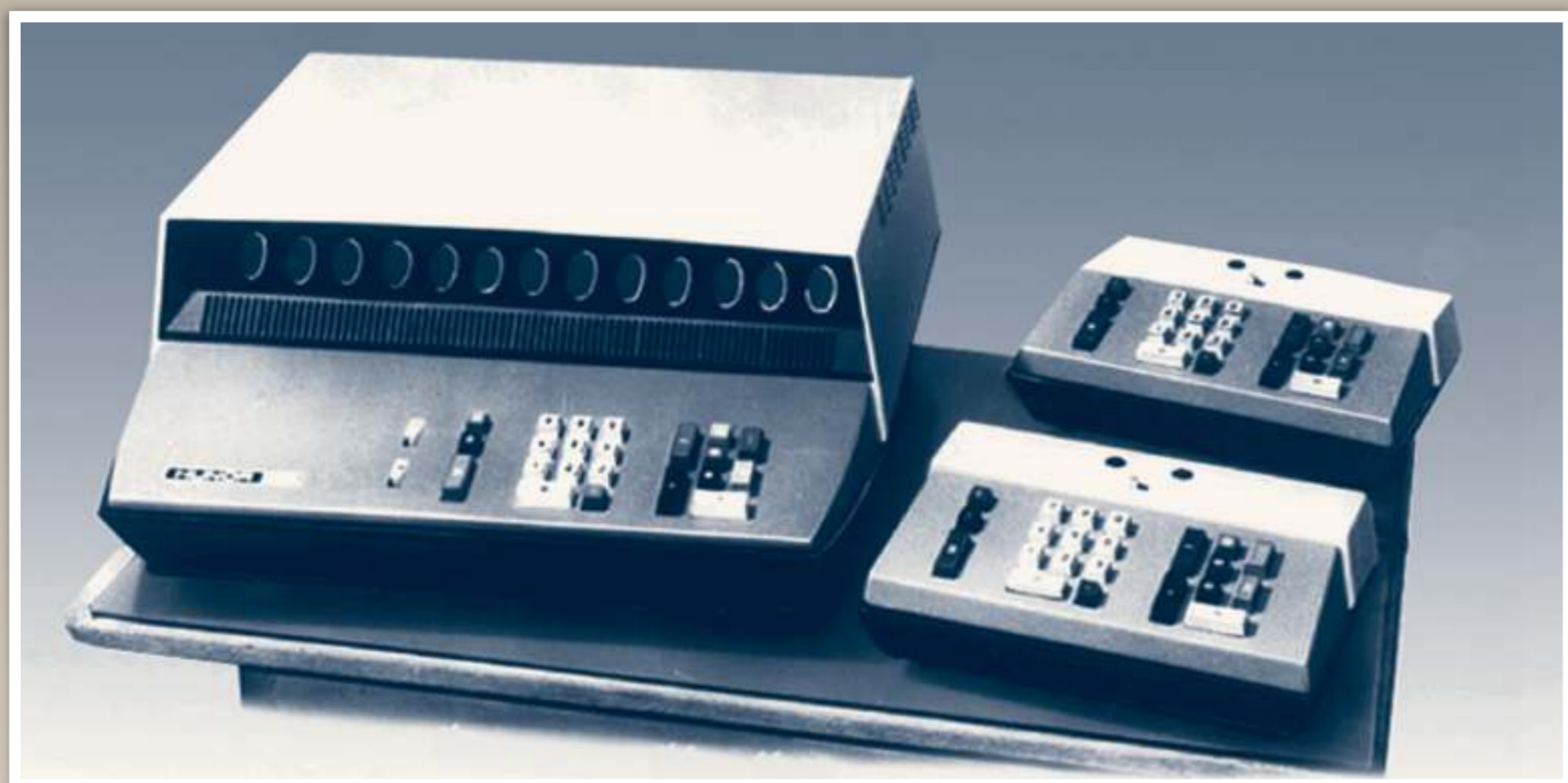
A Hunor asztali számológép két terminállal.
